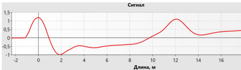
Рисунок 4 – Рефлектограмма с забивной сваи длиной 12 м
